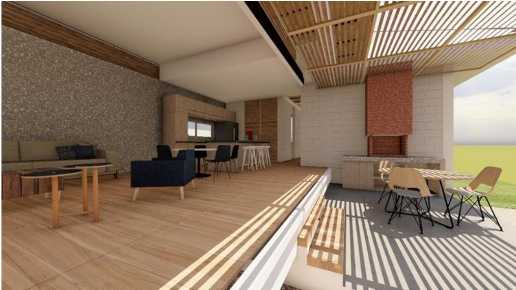
Figura 64 Render de área social abierta, cuando las pérgolas de bambú se abren en sentido horizontal para crear un alero de protección solar. Nota: Diseño modelado 3D en programa SketchUp y Lumion, autoría propia
