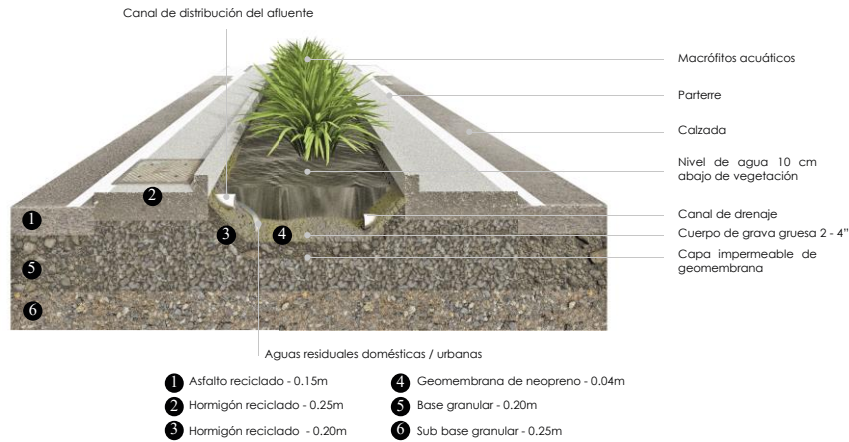
Figura. 68: Esquema de humedal artificial.
