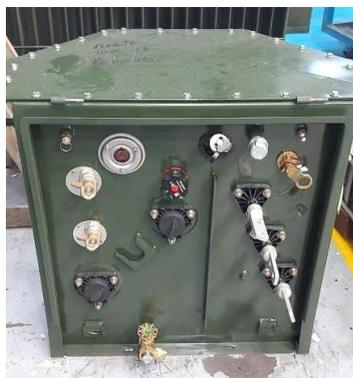
**Imagen 15:** Área de encube de parte activa del transformador trifásico.
