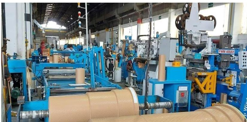
**Imagen 5:** Máquinas para preparar bobinas primario y secundario.
