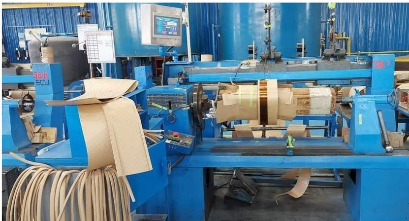
**Imagen 4:** Máquina torno para realizar las bobinas espirales.
