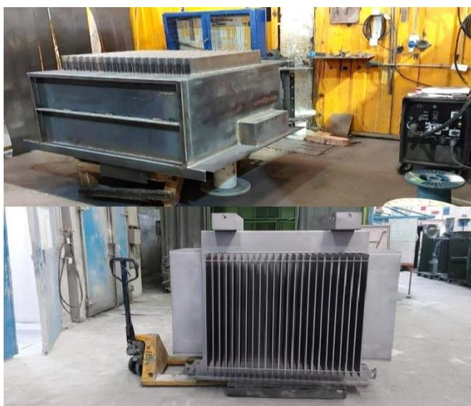
**Imagen 12:** Preparación, soldado, pulido y pintado del tanque.
