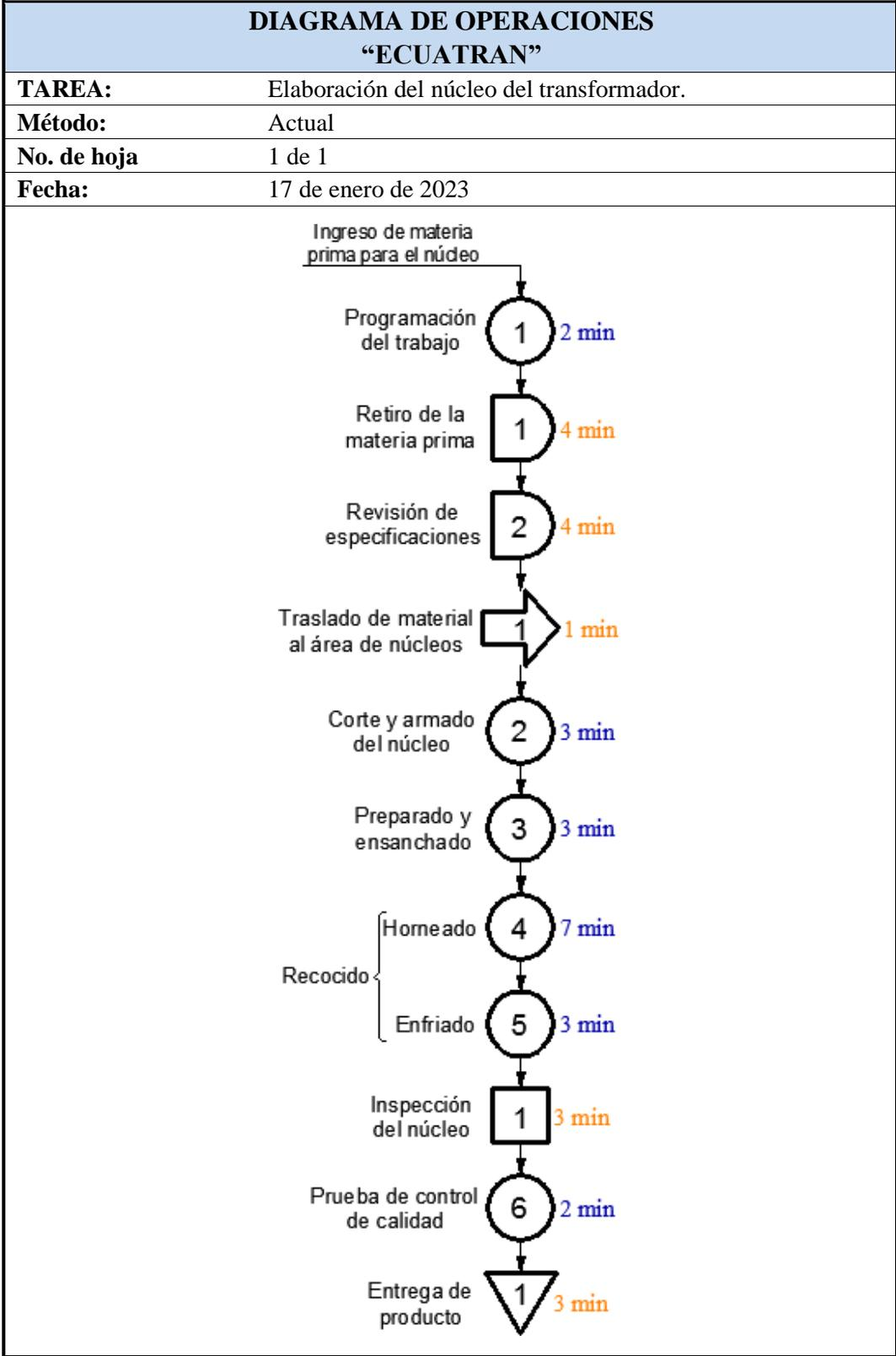
**Figura 9:** Diagrama de operaciones de la elaboración del núcleo del transformador.
