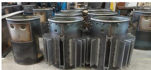
**Imagen 10:** Preparación de los tanques monofásicos para soldar y pulir.
