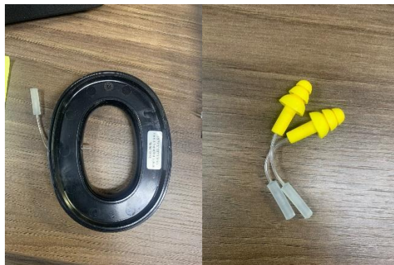
Figura 34: probetas para evaluación de aislante acústico de protectores tipo copa y de tipo inserción
