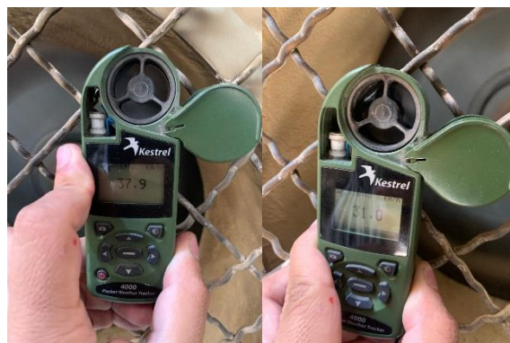
Figura 32: ingreso de aire en el ventilador M350 luego de la implementación equipo anemómetro
