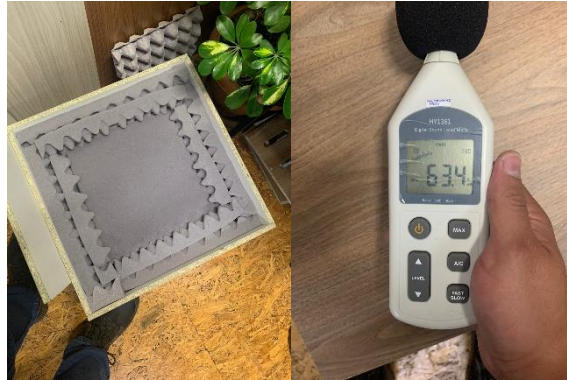
Figura 33: Prototipo de cámara acústica y medición de reducción
