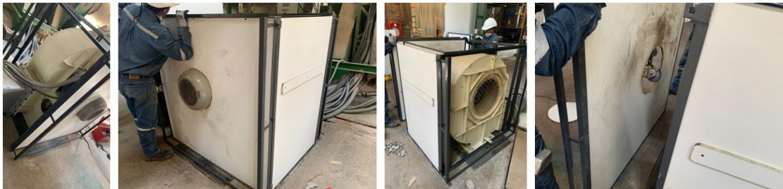
Figura 38: Fabricación de cámara acústica.
