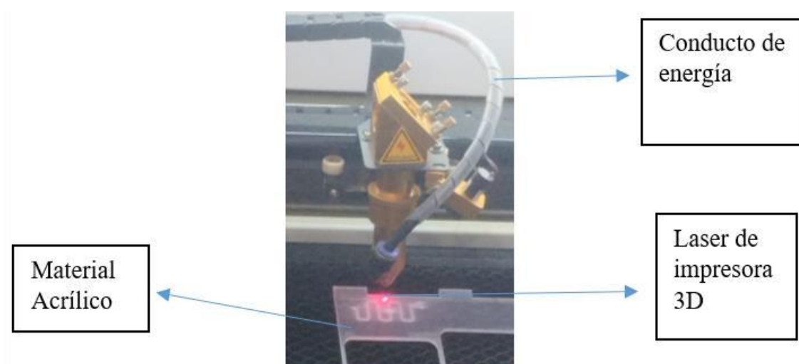
Imagen 11.- Impresión de microdispositivo por láser
