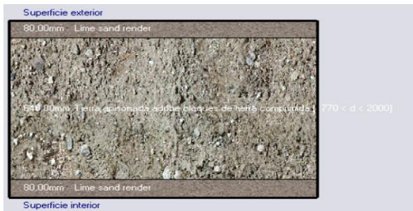
Fig 69. Recubrimiento de Particiones.
