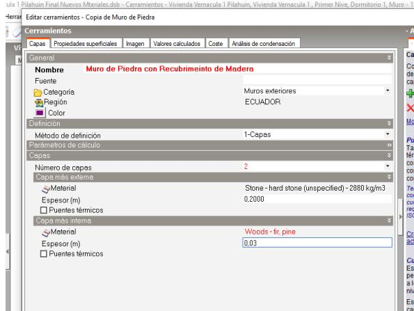
Fig 70. Configuración – Muros Nuevos Materiales.
