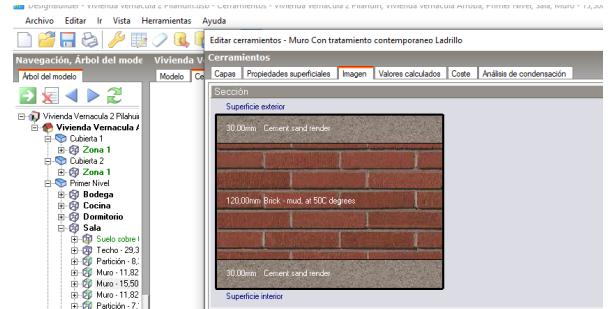
Fig 45. Configuración – Detalle Pared Contemporánea de Ladrillo.
