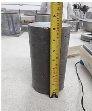
*Imagen 14.* Concreto hidráulico fabricado con 0,7% de fibra de vástago de banano cavendish.
