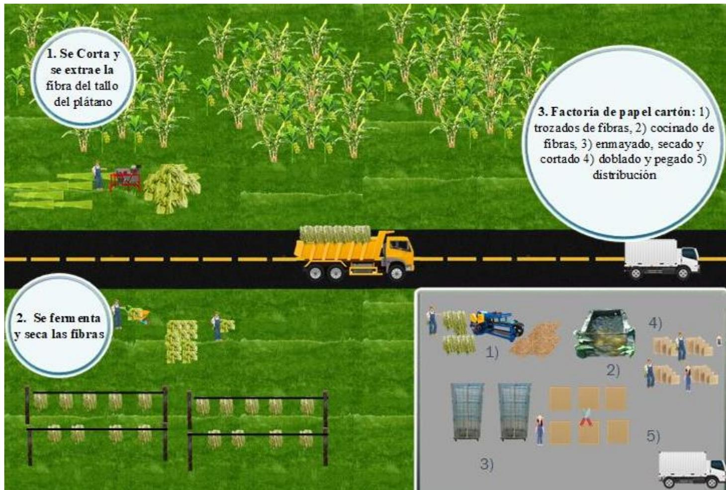
Imagen 11. Infografía del proceso de fabricación de fundas de papel a partir de los tallos de la planta de plátano barraganete.
