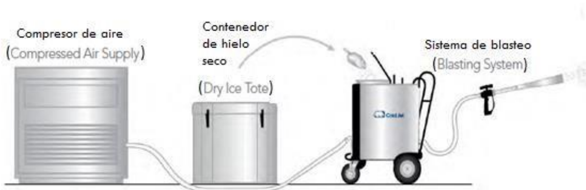
Imagen No. 7 Esquema de funcionamiento de máquina AERO 40FP
