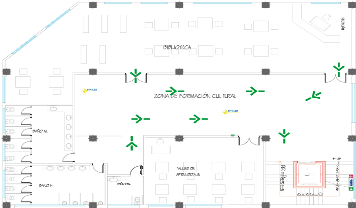
Primera Planta Alta Instalaciones de Salida de Emergencia Bloque 2
