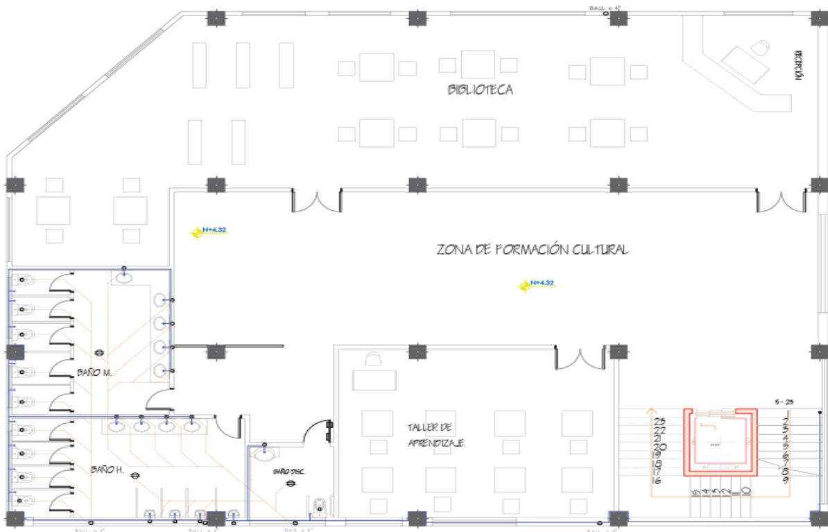
Primera Planta Alta Instalaciones Sanitarias Bloque 2
