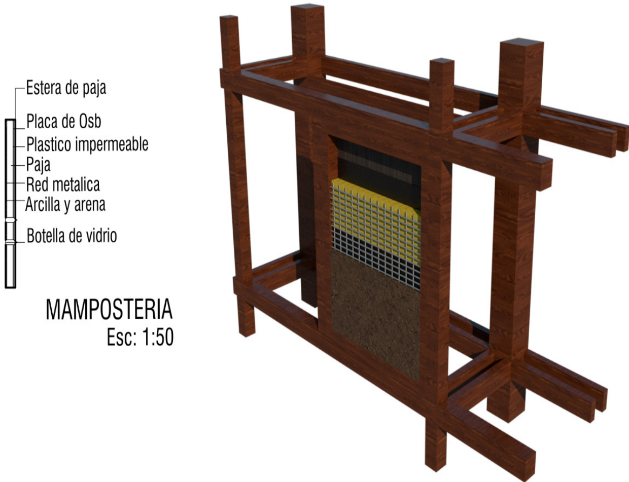
Figura 68. Detalle constructivo de mampostería.
