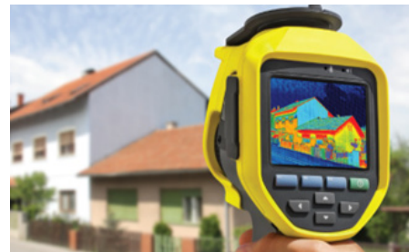
Figura 12. Medición de la acumulación de calor
