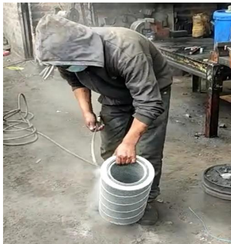
Imagen 11: Limpieza de filtros. Elaborado por: Zúñiga, Cristian (2022).
