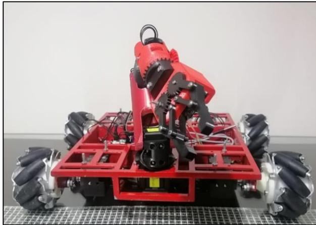
**Figura 48:** Ensamble final del manipulador móvil
