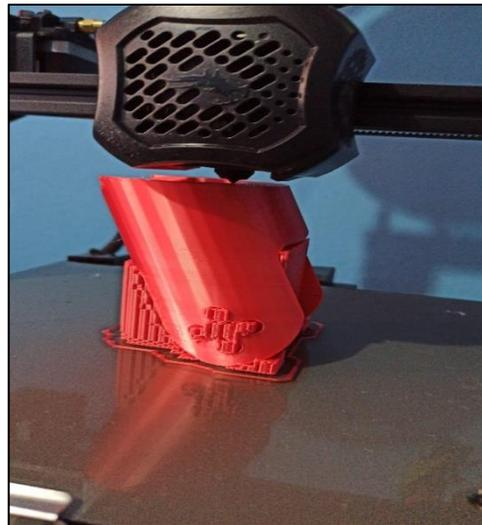
**Figura 45:** Impresión del primer eslabón
