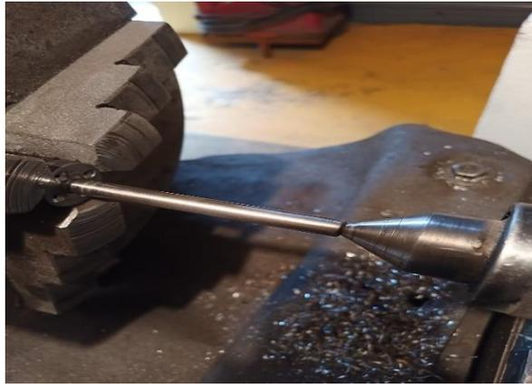
**Figura 43:** Construcción de los ejes de transmisión
