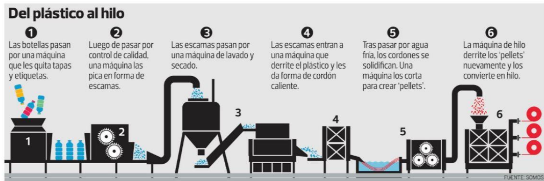
Gráfico 28: Proceso de transformación del polímero a hilo plástico
