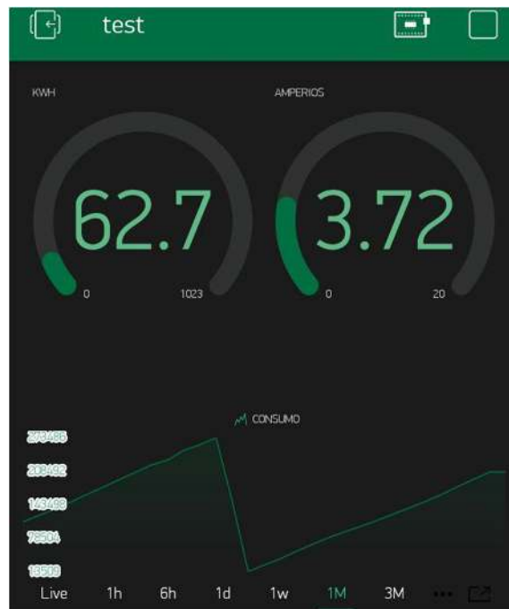
Imagen 18 Sistema de adquisición de datos trabajando de forma remota mediante el uso de Blynk
