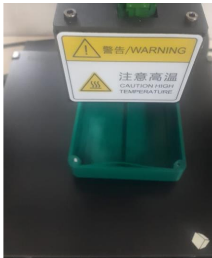
Figura 36-3. Impresión final tapa base Realizado por: Silva, Steven (2022)
