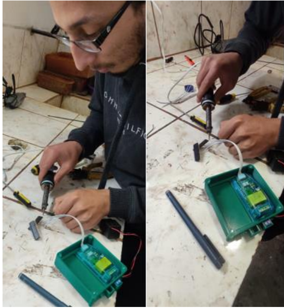
Figura 44-3. Conexión de los cables del primer sensor a los espadines Elaborado por: Silva, Steven (2022)
