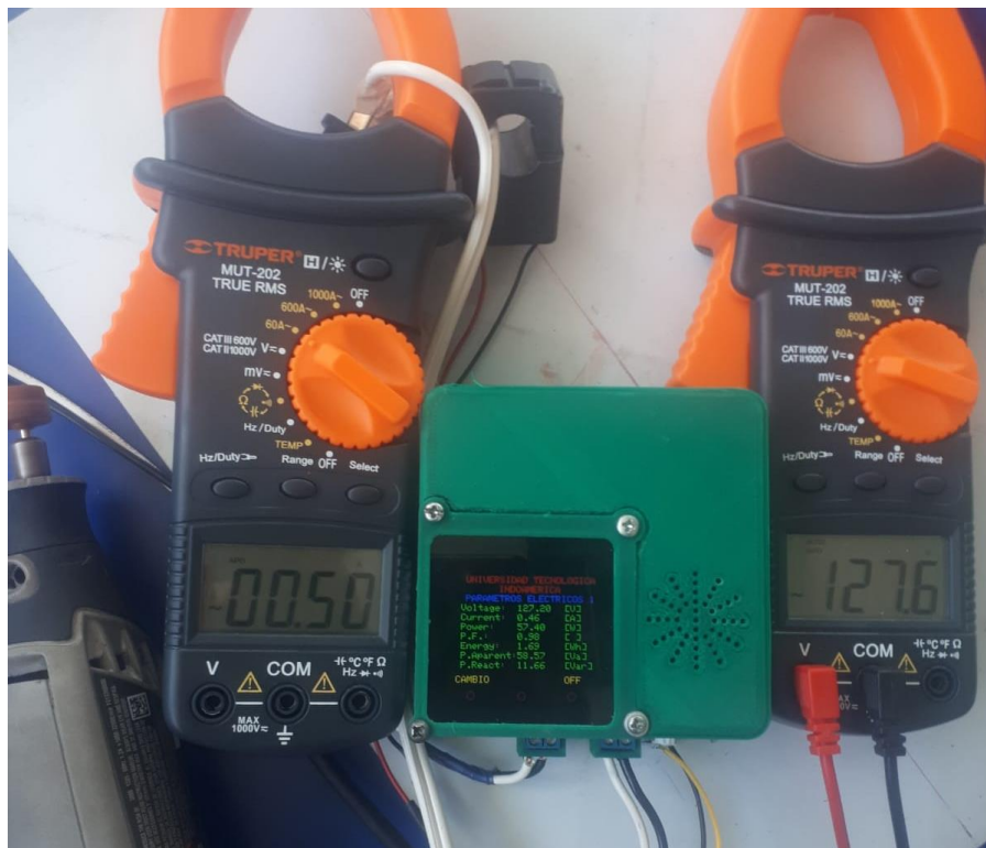
Figura 49-3. Medición del dremel con el medidor de factor de potencia y multímetro tipo gancho Elaborado por: Silva, Steven (2022)
