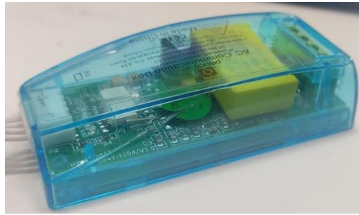
Figura 19-3. Sensor pzem-004t real Elaborado por: Silva, Steven (2022)
