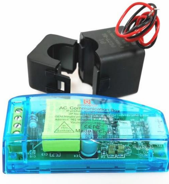
Figura 16-3. Sensor pzem-004t Fuente: (Amazon 2022)
