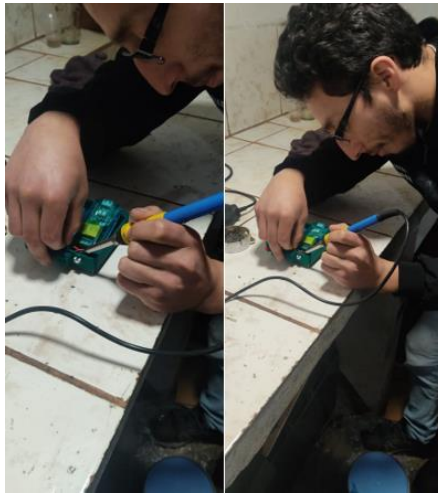
Figura 41-3. Suelda de las borneras de entrada Elaborado por: Silva, Steven (2022)
