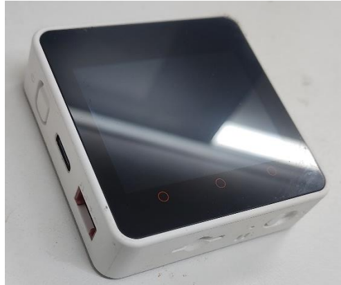
Figura 22-3. M5Stack Core2 real Elaborado por: Silva, Steven (2022)
