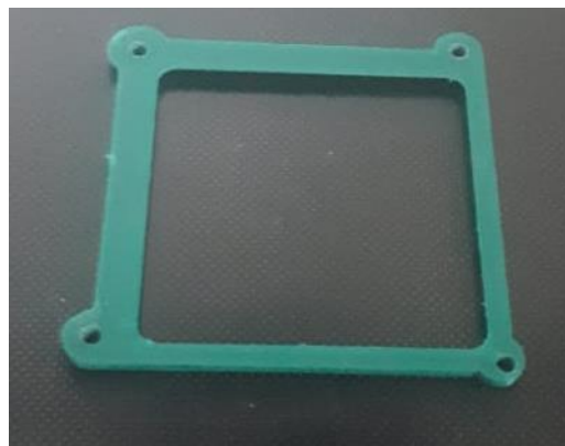
Figura 40-3. Impresión final tapa protección M5Stack Core2
