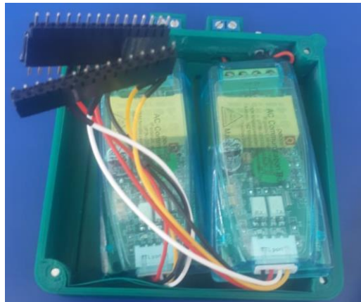
Figura 45-3. Conexión de los sensores a los espadines Elaborado por: Silva, Steven (2022)
