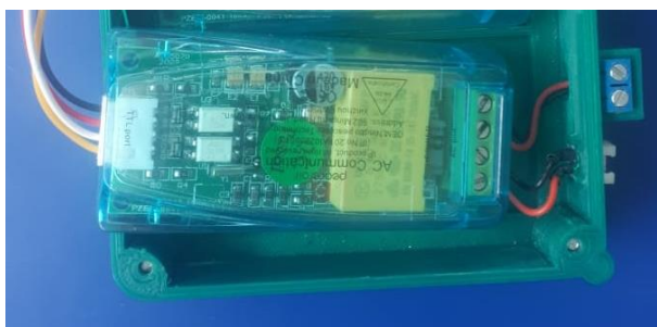
Figura 42-3. Conexión del pzem-004t con los conectores de 4 pines Elaborado por: Silva, Steven (2022)
