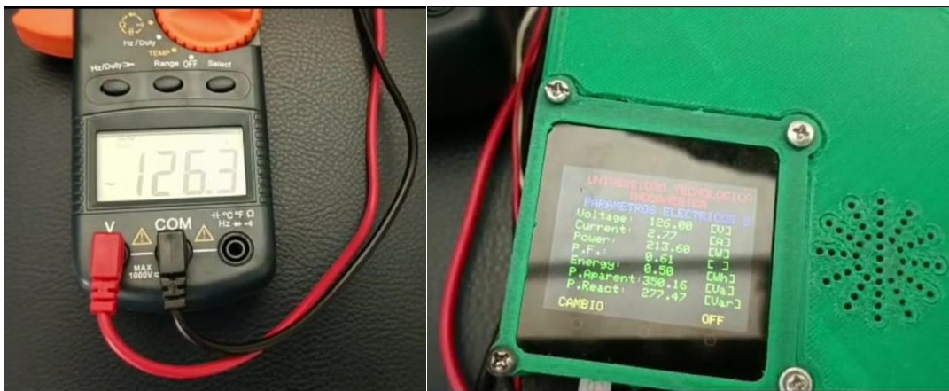
Figura 50-3. Medición de voltaje Elaborado por: Silva, Steven (2022)
