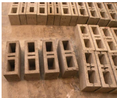
Figura 3. Bloque con Cascarilla de arroz Fuente: Martínez Pérez, 2018
