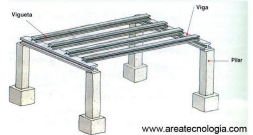
Imagen 3: Conexión de vigas, viguetas y pilares
