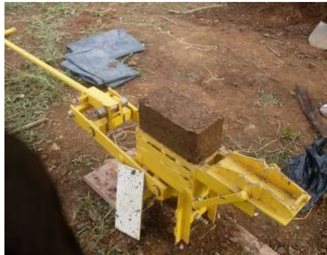
Figura 89. Bloque comprimido de tierra Fuente: colocación de bloque
