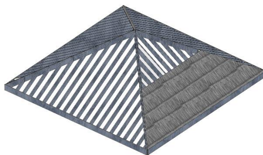
Figura 31. Cubierta de entablonado y paja
