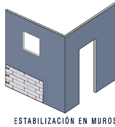
Figura 39. Estabilización en muros con bloques
