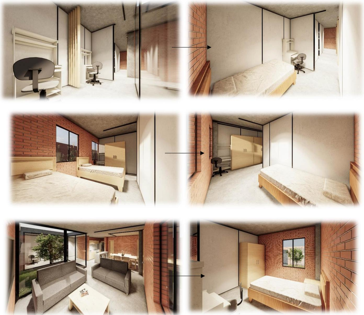
Nota: El gráfico muestra la flexibilidad espacial y las distintas configuraciones espaciales que ofrece la vivienda según se lo requiera, gracias a las paredes móviles de gypsum que posee.
