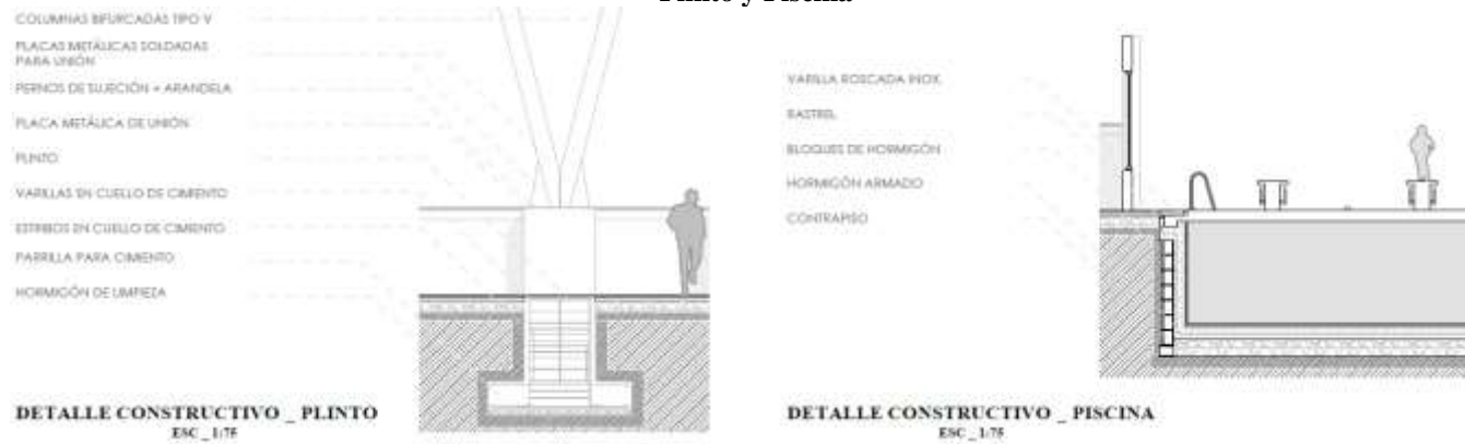
Figura 79. Plinto y Piscina
