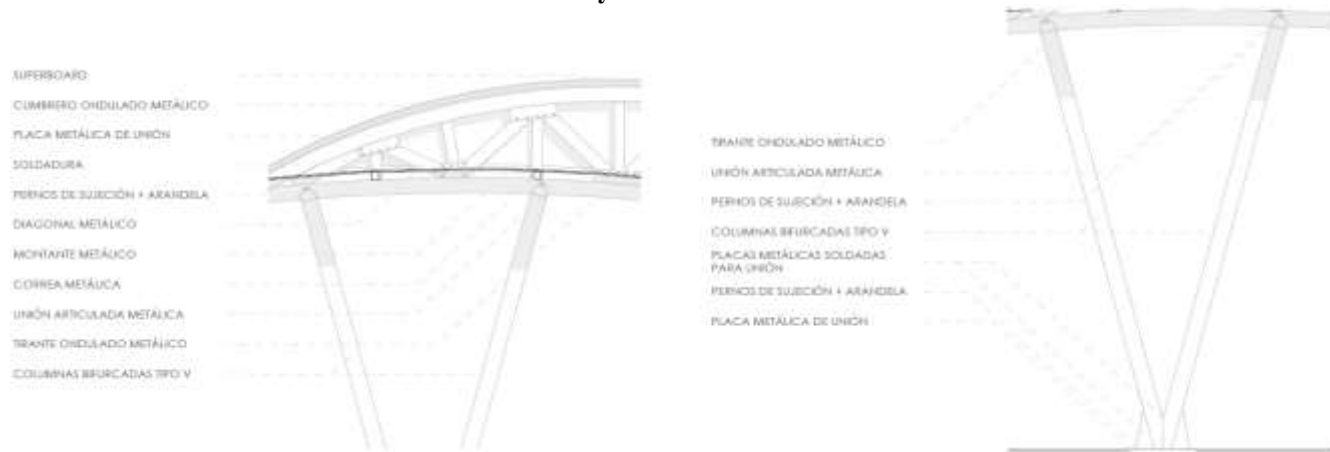
Figura 78. Cerchas y Columnas Bifurcadas
