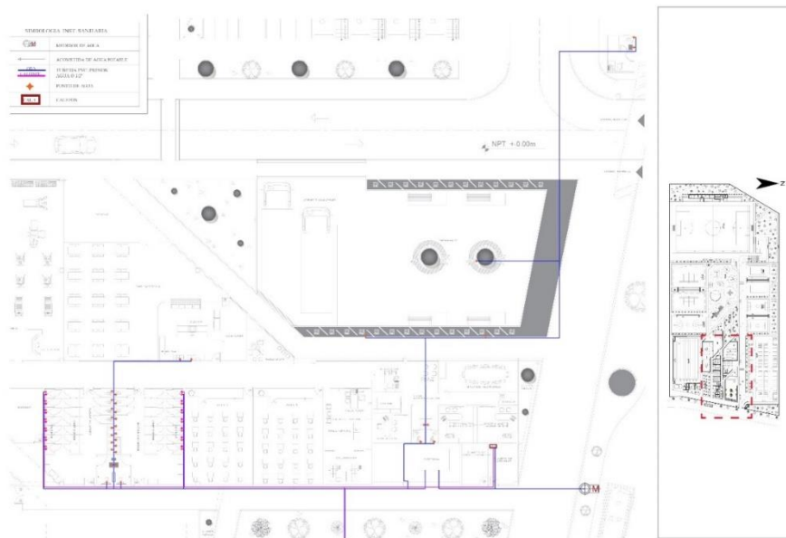
Figura 123. Instalaciones hidráulicas del equipamiento-espejo de agua
