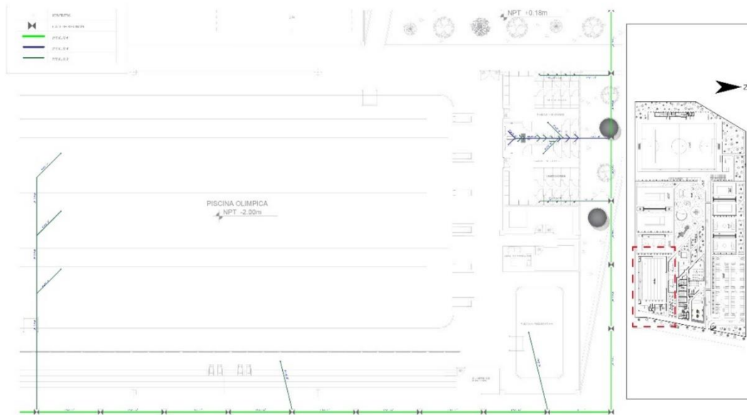
Figura 126. Instalaciones sanitarias de la piscina
