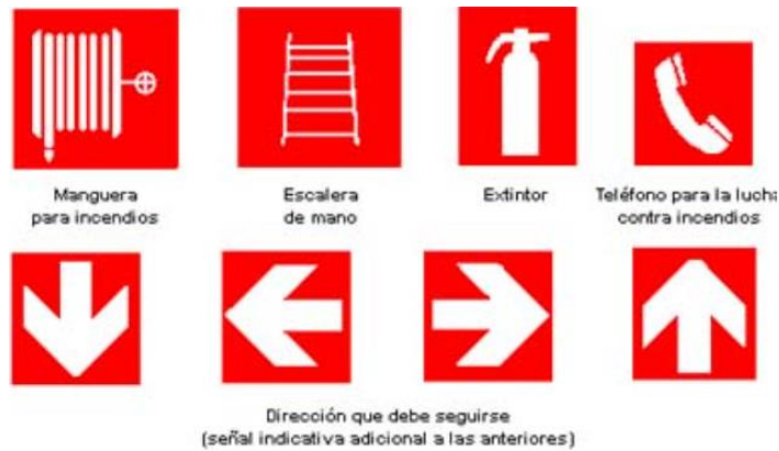
Figura 5 Señales contra incendios Fuente: Real Decreto 485/1997 Autor: Ministerio de Trabajo y Asuntos Sociales
