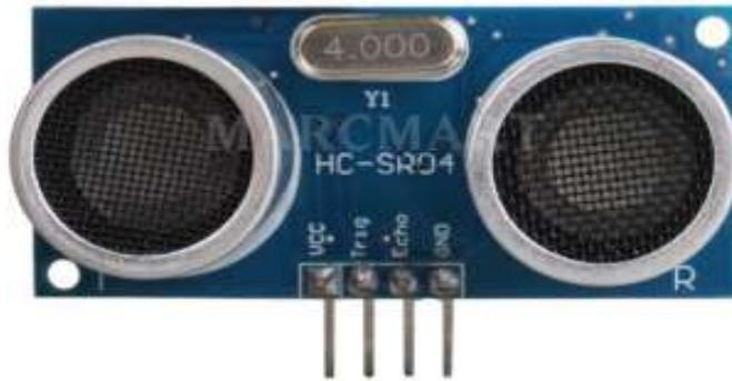
Figura 11. Sensor ultrasonido HC - SR04 [18]
