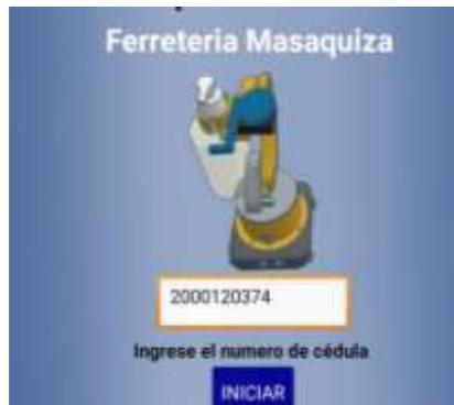
Una vez presionado el botón indicar continuara con la interfaz de control robot que será la encargada de medir la temperatura y el pulso corporal, si la temperatura excede los 38°C enviara una alerta y no permite la entrega de gel desinfectante si la temperatura es inferior continuara con la entrega de gel desinfectante y con la lectura del pulso corporal. Termina dicho proceso los datos se actualizarán en los datos pertenecientes al número de cedula, estos datos se visualizarán en los reportes.
