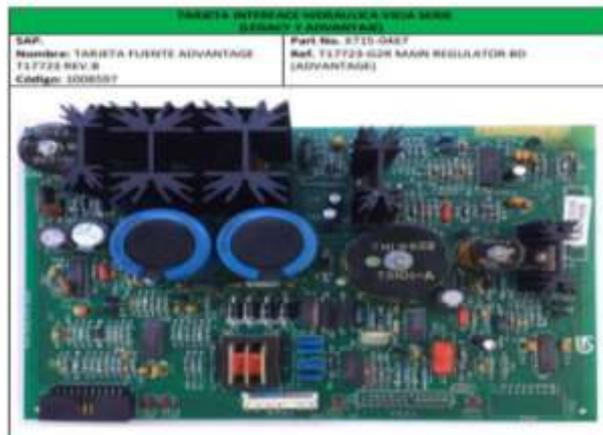
Figura 4. Tarjeta controladora[11]
