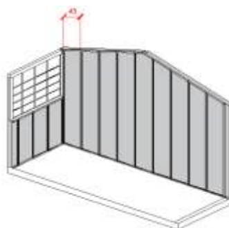
Gráfico N°48. Armado de marco con parantes sobre pared preexistente
