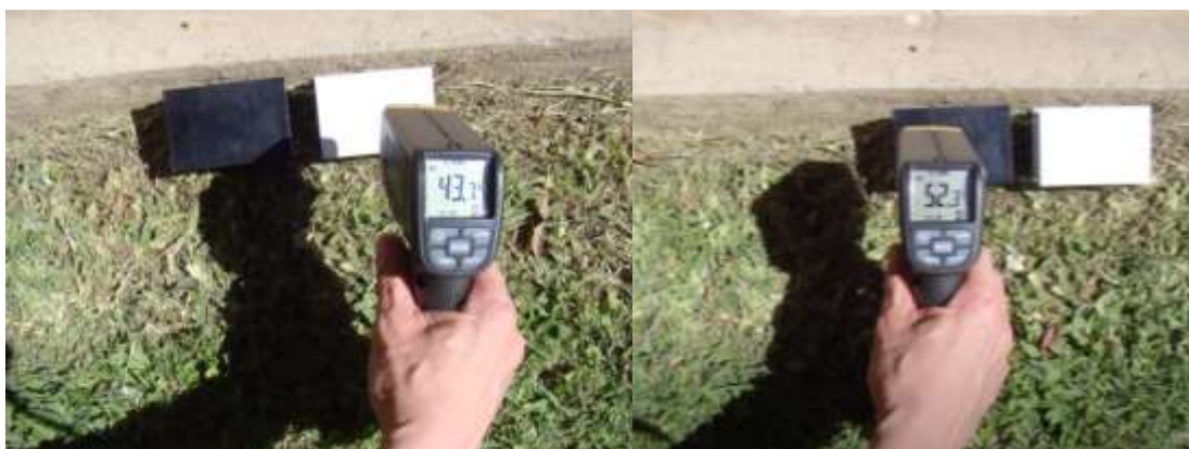
Figura N°47. Medición con termómetro de superficies sobre piezas metálicas de distinto color.
