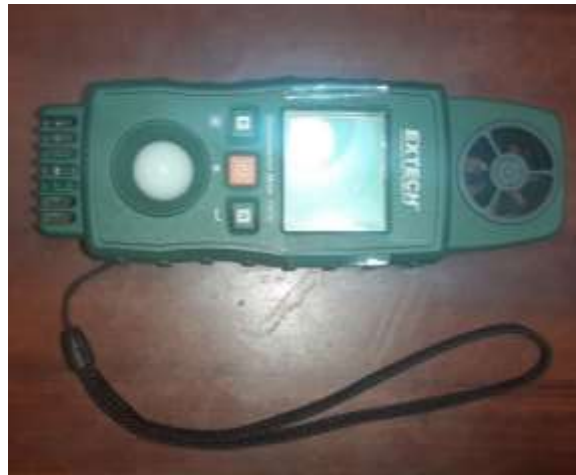
Gráfico N°16. Medidor Ambiental Multifunción
