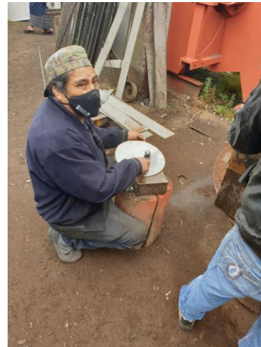
Rayado de piezas a perforar
