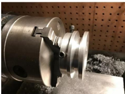
Torneado de poleas en el torno
