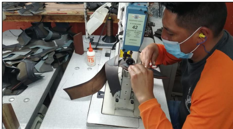
Imagen 7 Proceso de Aparado. Fuente: Calzado Gamo's
