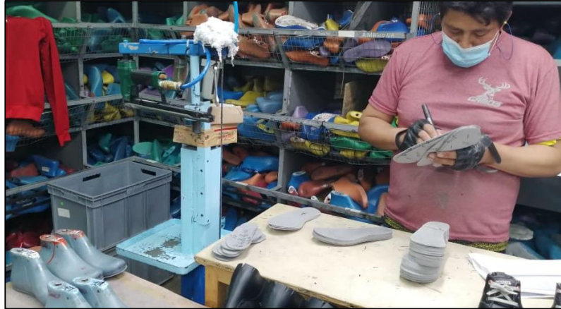
Imagen 11 Emplantillado. Fuente: Calzado Gamo´s
