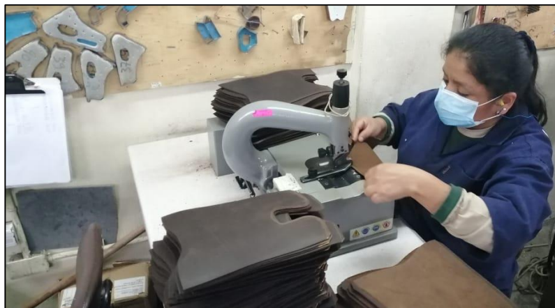
Imagen 5 Proceso de Desbastado Fuente: Calzado Gamo's
