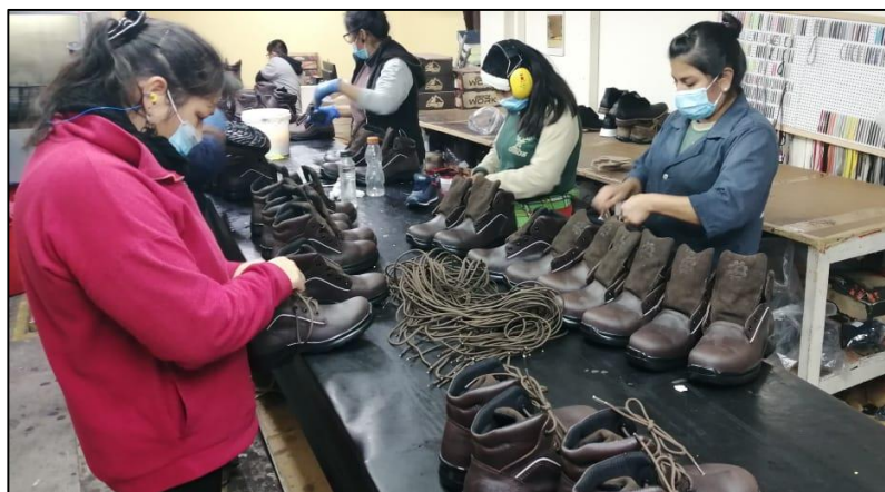
Imagen 12 Proceso de Terminado. Fuente: Calzado Gamo´s
