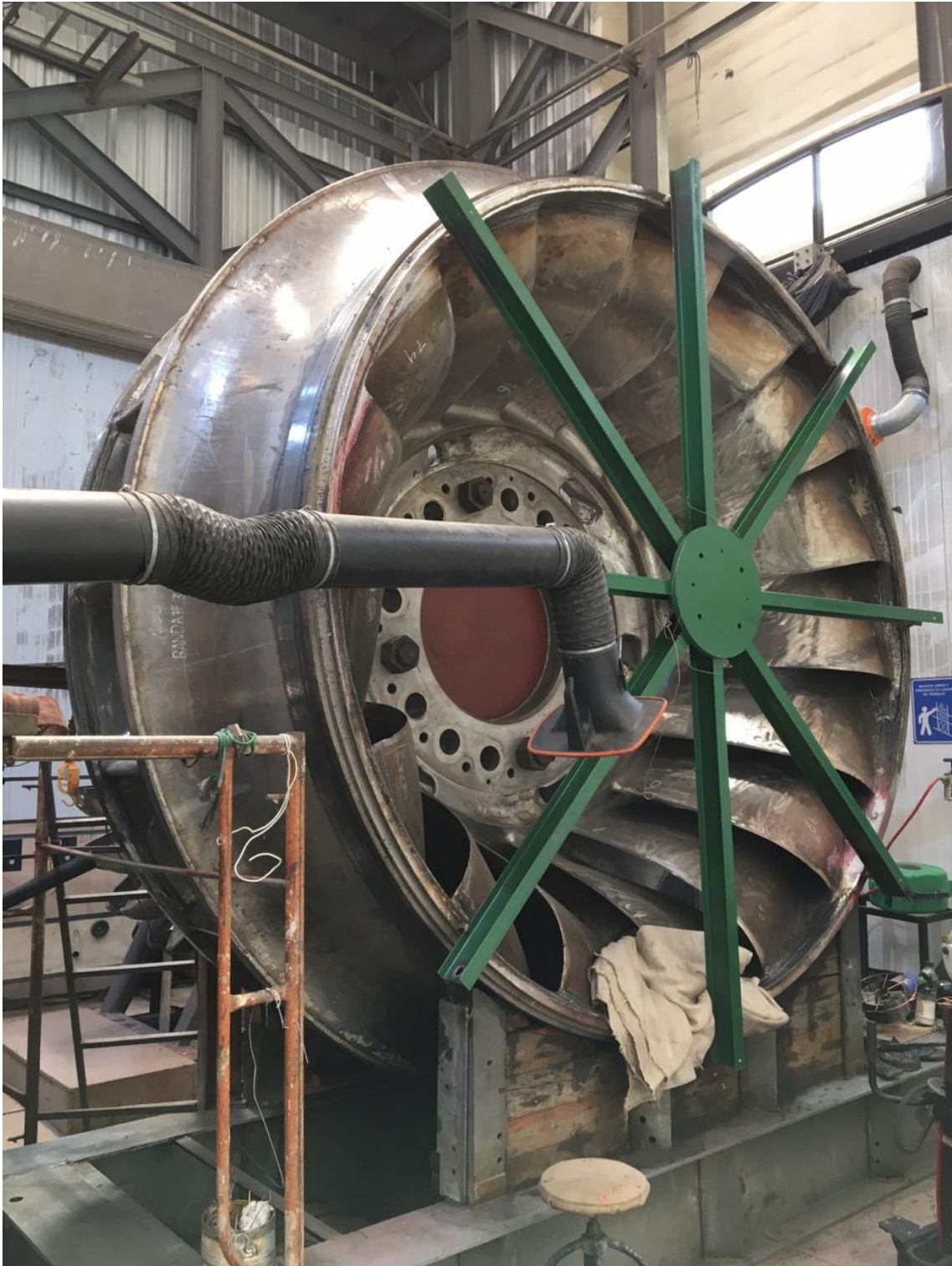
Anexo 8: Turbina Francis inspección Fuente: (CIRT, 2020)
