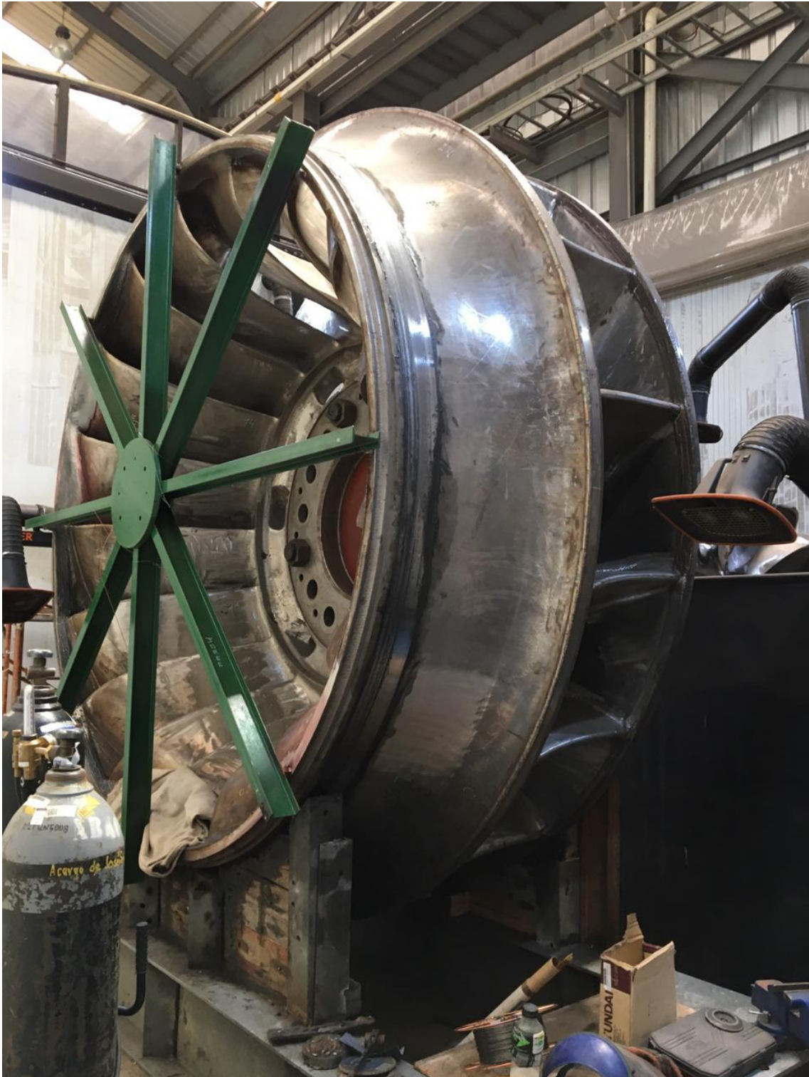
Anexo 7: Turbina Francis área de maquinado Fuente: (CIRT, 2020)
