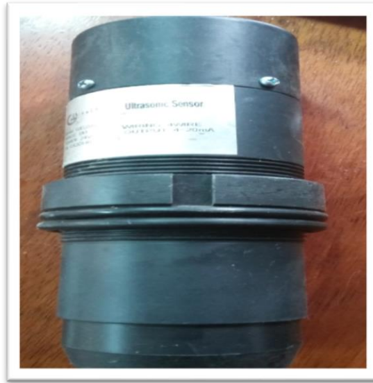
Figura 82: Sensor de Nivel Fuente: PTAR
