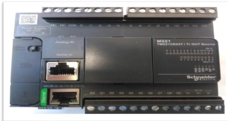
Figura 75: PLC Fuente: PTAR
