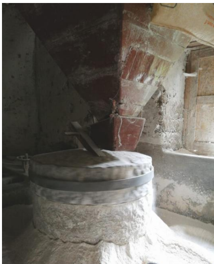
Figura 32 Estructura Tolva y piedras moledoras en funcionamiento
