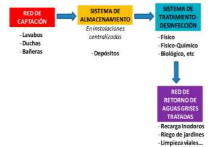
Figura 97 Sistema de captación de agua Fuente: (Rull, 2018)
