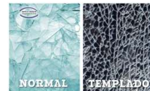
Figura 90 Rotura de vidrio templado Fuente: Megaluminio, 2018
