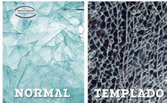
Gráfico 94: Rotura de vidrio templado
