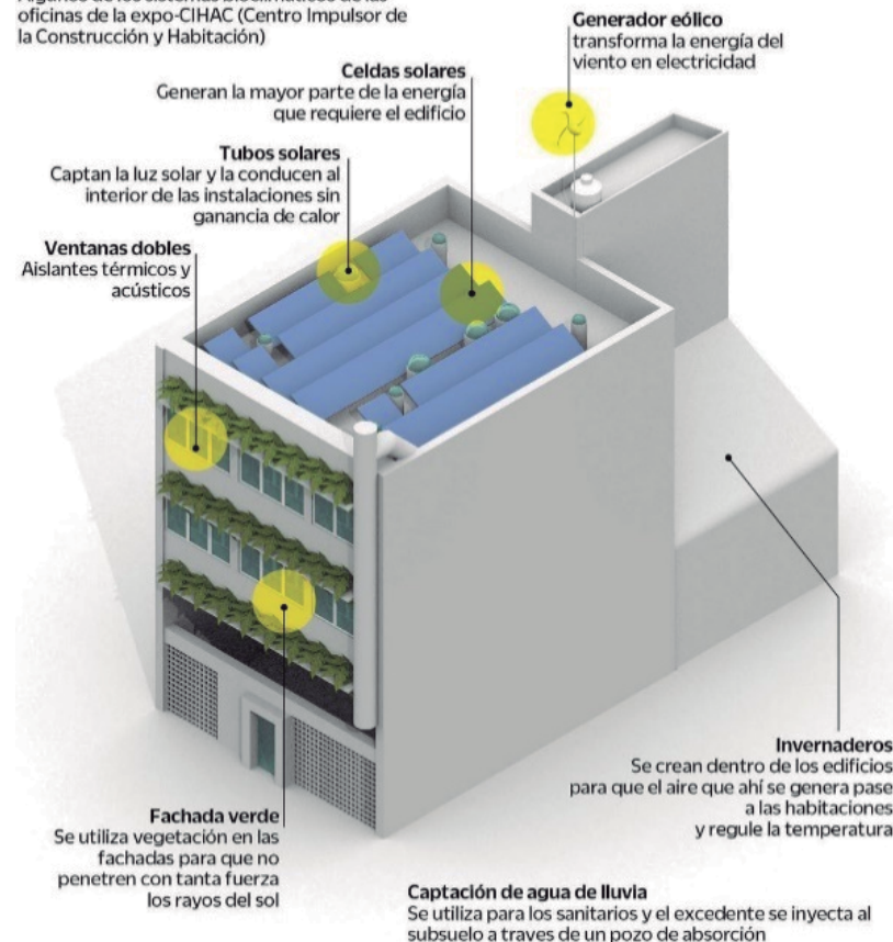
Gráfico No. 139: Sistemas bioclimáticos de un edificio.
