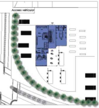
Muro Verde que permitira filtrar el sonido hacia las diferentes areas a usar en la torre
