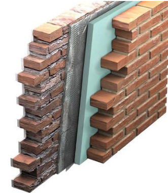
Imagen N.64 Cámara de aire Fuente: Estudio Barthes
