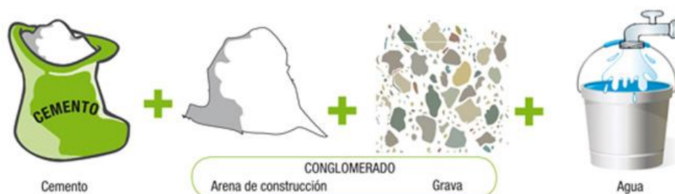
Imagen 16. Materiales para elaborar el hormigón Fuente: goo.gl/kMIQYB
