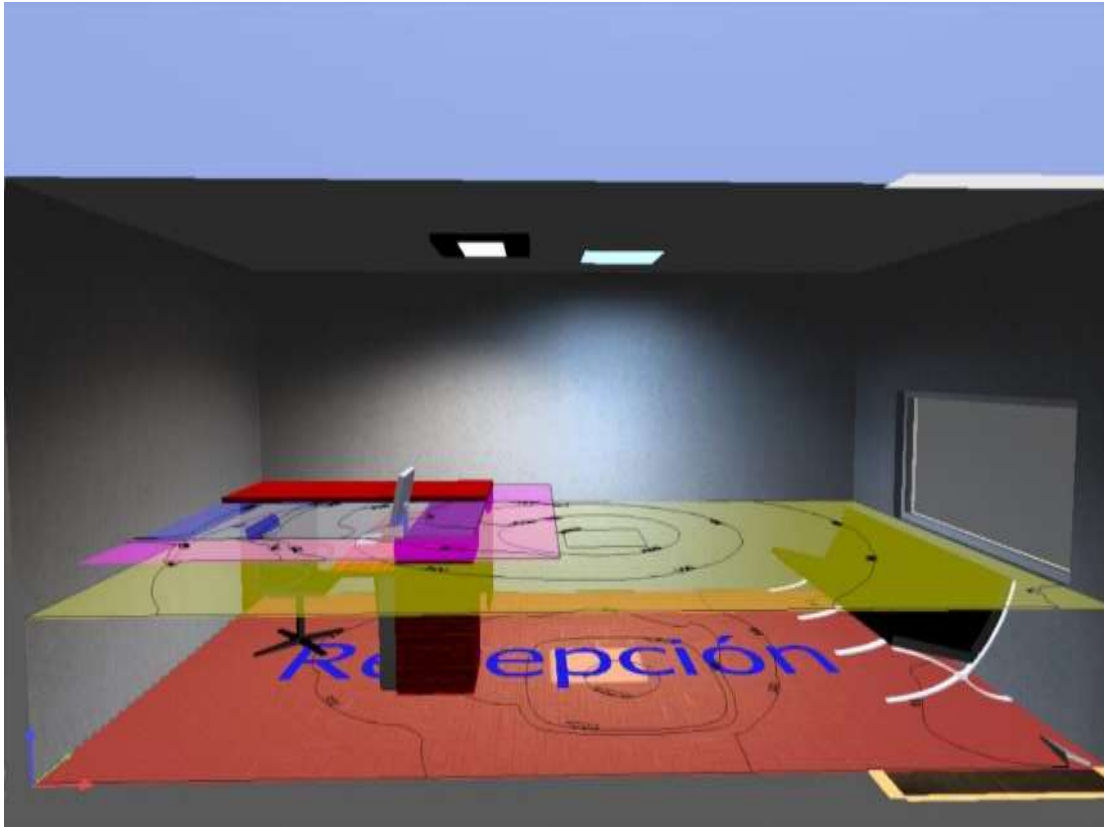
Figura N° 27: Colocación de luminaria y simulación del software recepción.
