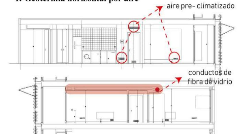
En las viviendas se introduce aire pre-climatizado a 18°C (tanto en verano como en invierno) a través de rejillas de impulsión situadas junto al suelo en la sala de estar y en los dormitorios (mediante conductos empotrados de fibra de vidrio-aluminio). Este aire ayuda a calefactar las viviendas en invierno, y a refrescarlas en verano sin tener que recurrir a aparatos de aire acondicionado
