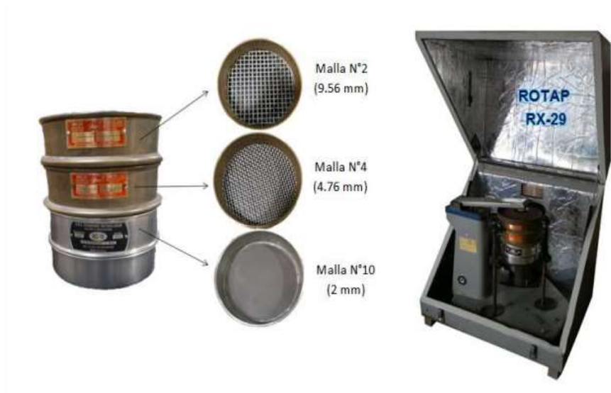
Imagen N. ° 31: Malla Utilizadas en el proceso de tamizado del EPS triturador y equipado ROTAP perteneciente al CICY
