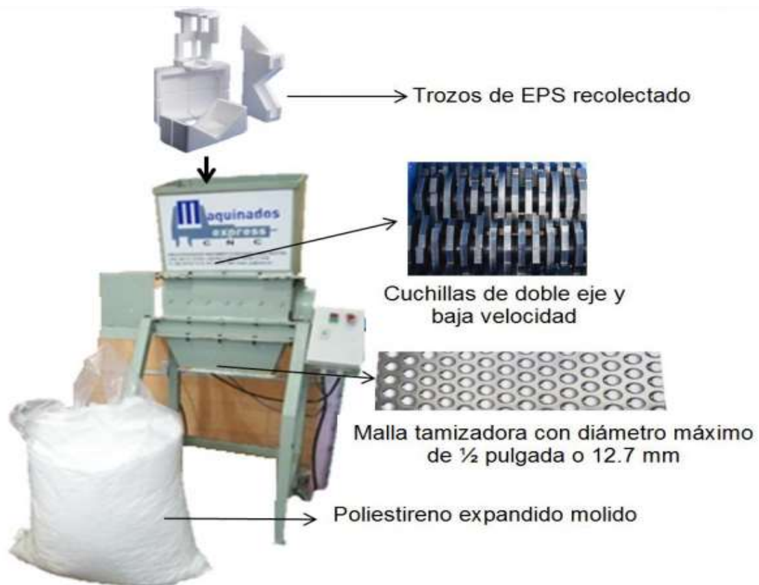
Imagen N.º 34: Características del molino utilizado para la molienda del EPS recolectado
