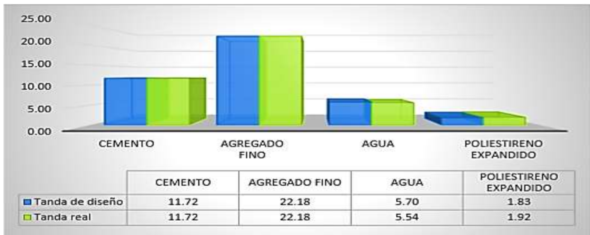
Imagen 39: Dosificación del Concreto Ligero para densidad Fuente: (Rivera, 2015)
