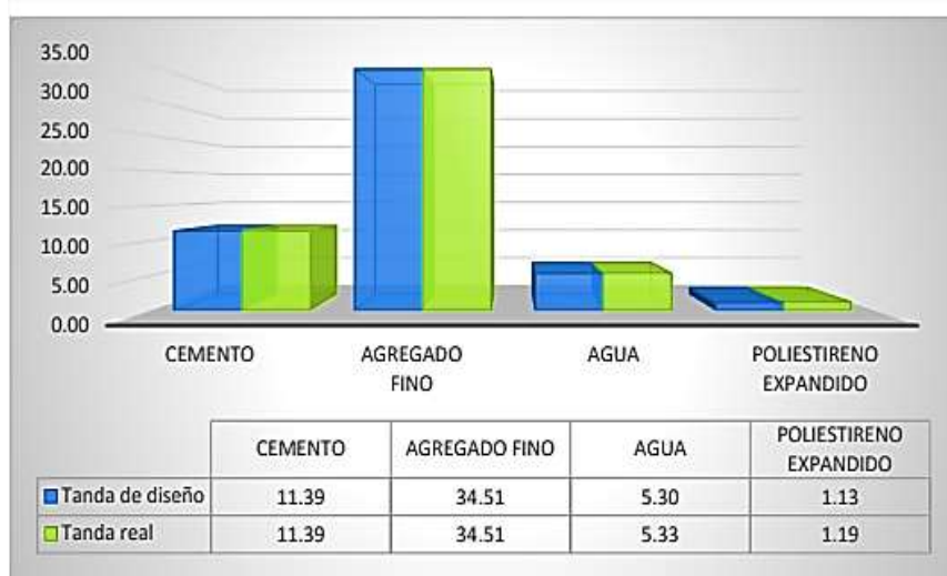
Imagen 41: Dosificación del Concreto Ligero para densidad aparente de 1200 Kg/m 3 Fuente: (Rivera, 2015)
