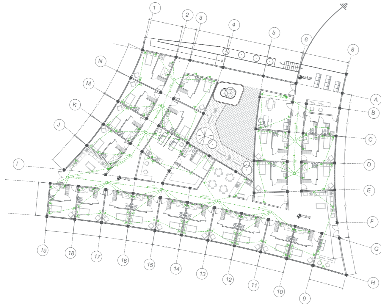
TOMAS ELECTRICAS BLOQUE RESIDENCIA
