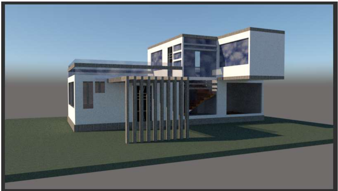
Construcción con el uso de dos contenedores de doce (12) pies y dos de seis (6) pies
