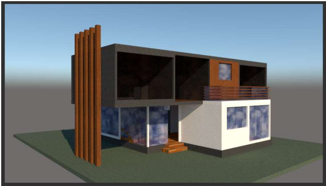
Construcción con el uso de tres contenedores de doce (12) pies y dos de seis (6) pies
