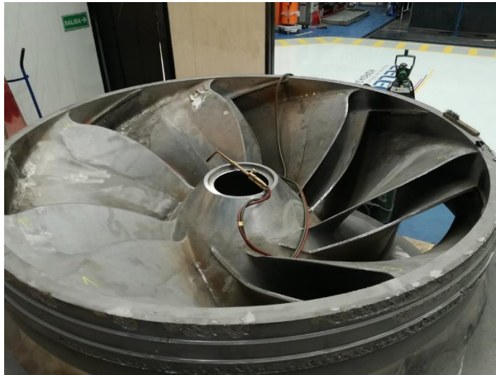
Imagen 8: Corte de secciones fatigadas de álabes fijos.
