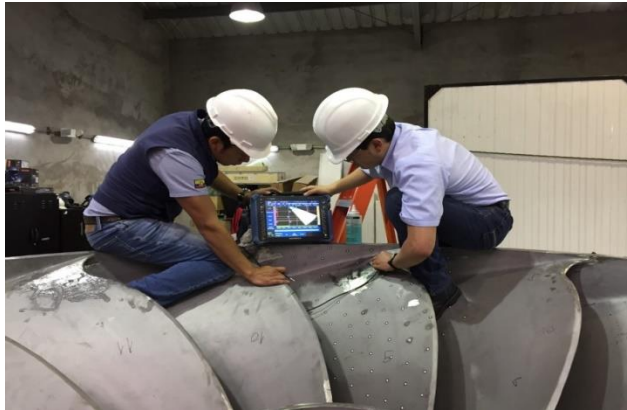
Imagen 16: Prueba de ultrasonido en el rodete Francis.
