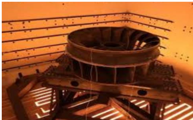
Imagen 15: Rodete Francis en el horno para tratamiento térmico.
