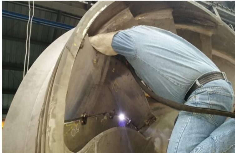
Imagen 13: Soldadura de insertos metálicos en el rodete.
