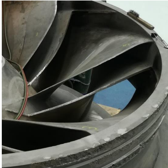
Imagen 12: Juntas biseladas para soldadura de insertos de álabes fijos.
