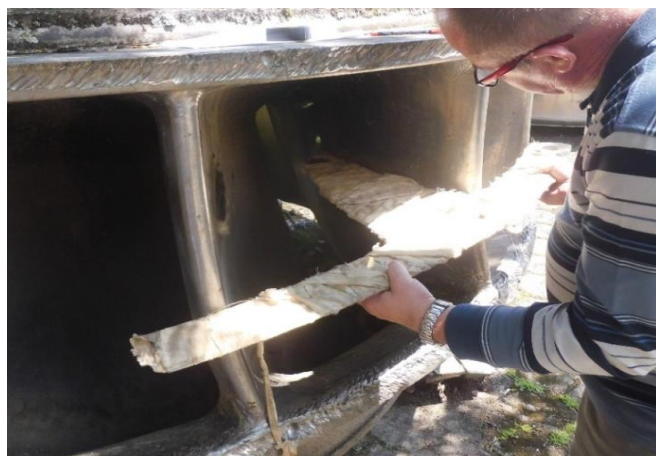
Imagen 6: Comparación del desgaste con plantillas.
