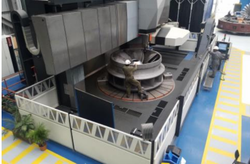
Imagen 9: Maquinado del rodete Francis con el torno vertical.
