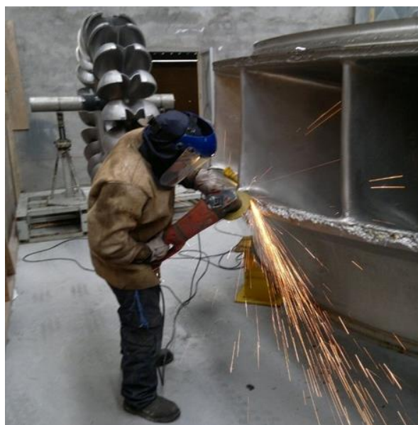
Imagen 11: Desbaste de soldadura en filo de la corona del rodete Francis.
