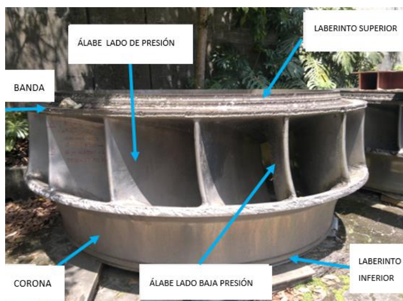
Imagen 22: Partes del rodete tipo Francis. Fuente: CELEC EP. (2017)
