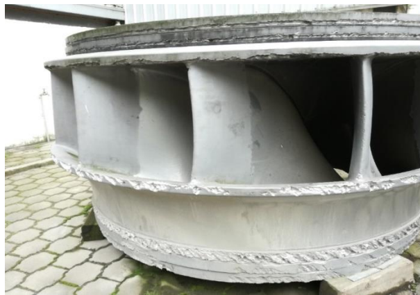
Imagen 4: Rodete Francis en la Central Hidroeléctrica de origen.
