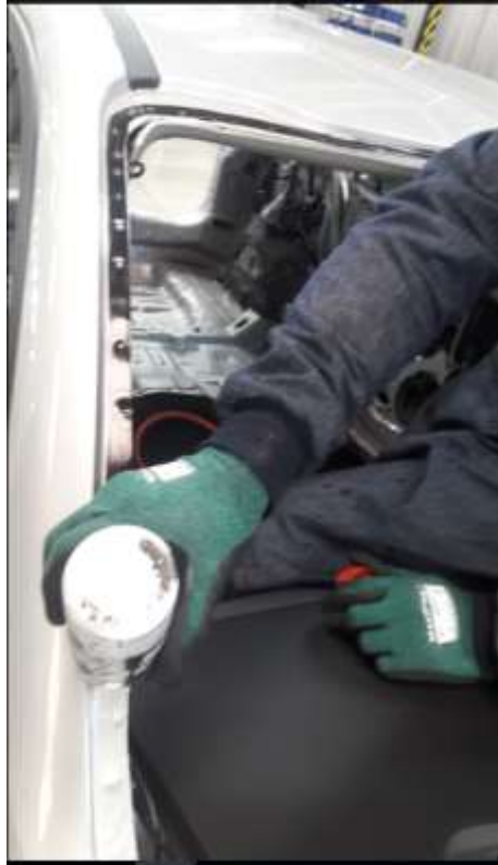
Imagen N° 8.- Instalación primer de carrocería Fuente: Aymesa S.A.
