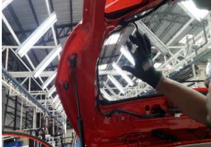
Imagen N° 20.- Control de exceso de poliuretano luneta posterior Fuente: Aymesa S.A.
