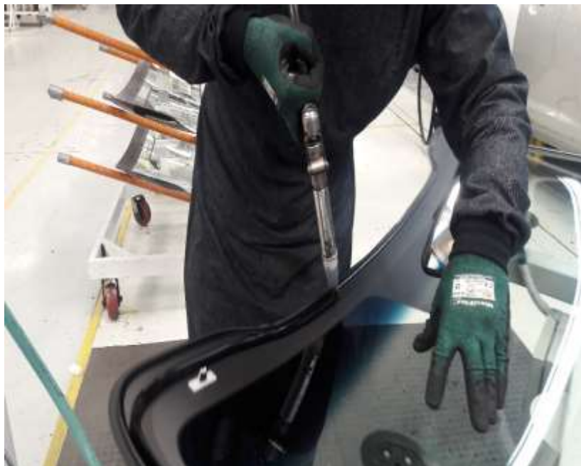
Imagen N° 9.- Aplicación sellante poliuretano para pegado directo parabrisas laminado delantero Fuente: Aymesa S.A.
