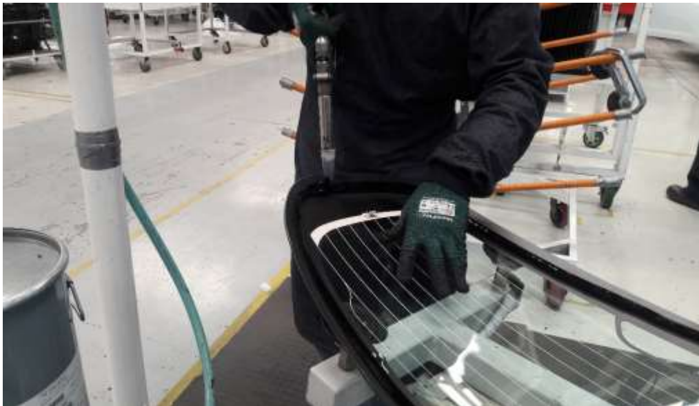
Imagen N° 15.- Aplicación sellante poliuretano para pegado directo luneta posterior Fuente: Aymes S.A.
