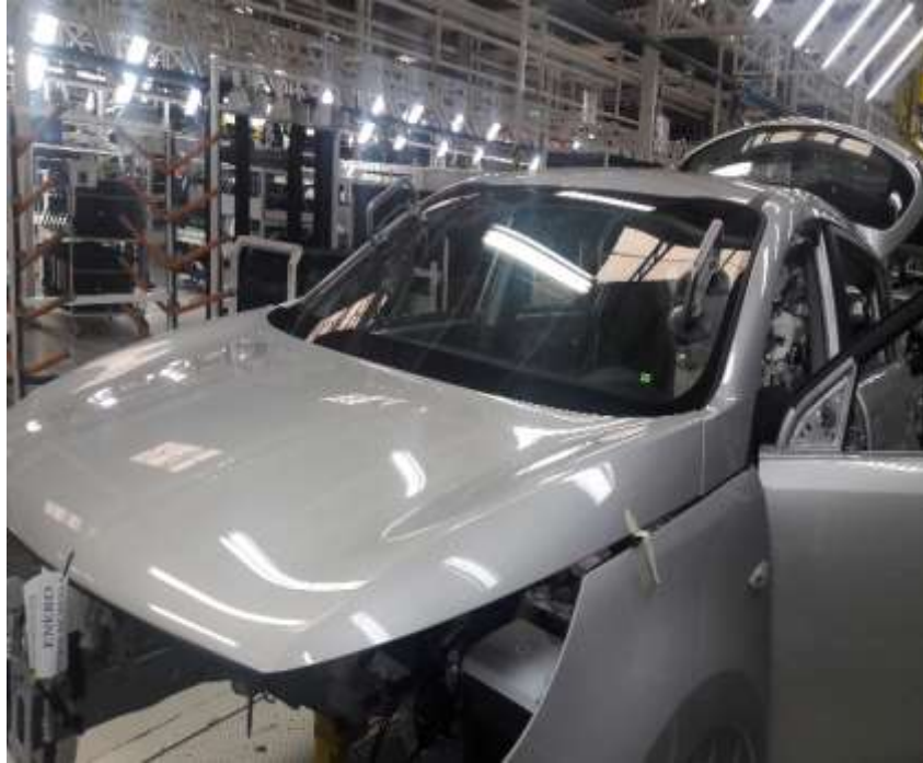
Imagen N° 10.- Montaje parabrisas en la carrocería Fuente: Aymesa S.A
