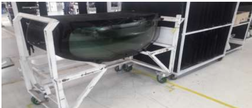
Imagen N° 12.- Fijación sitio de trabajo diseño rack de 20 unidades Fuente: Aymesa S.A
