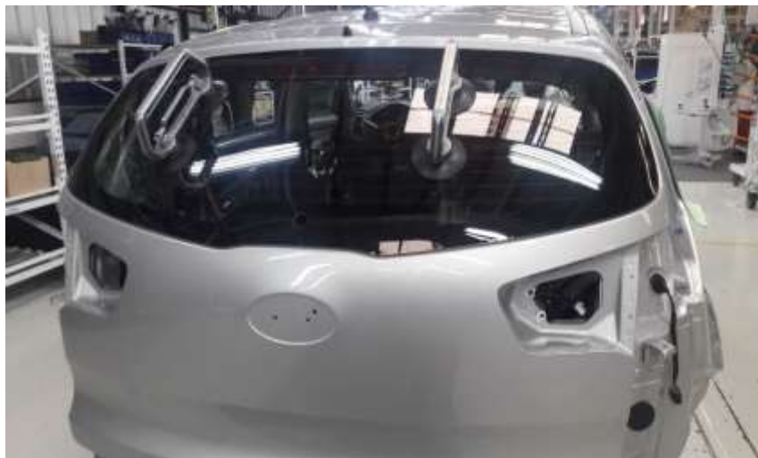
Imagen N° 18.- Instalación luneta posterior Sportage R SL Fuente: Aymesa S.A.
