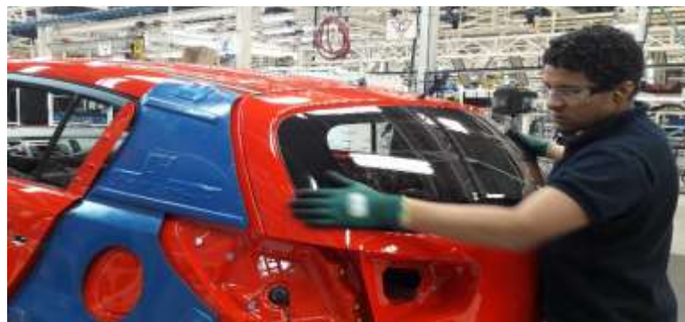
Imagen N° 19.- Inspección de rayas luneta posterior
