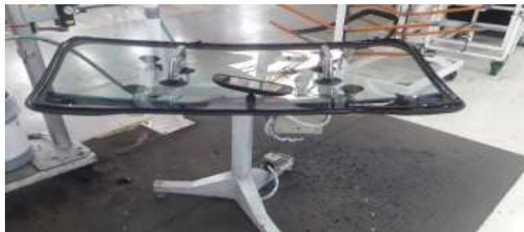
Imagen N° 7.- Instalación de poliuretano parabrisas delantero
