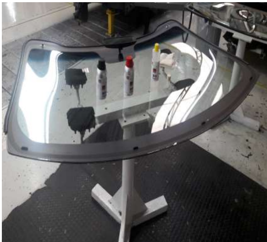
Imagen N° 5.- Aplicación de los componentes químicos para el sub-ensamble parabrisas laminado delantero
