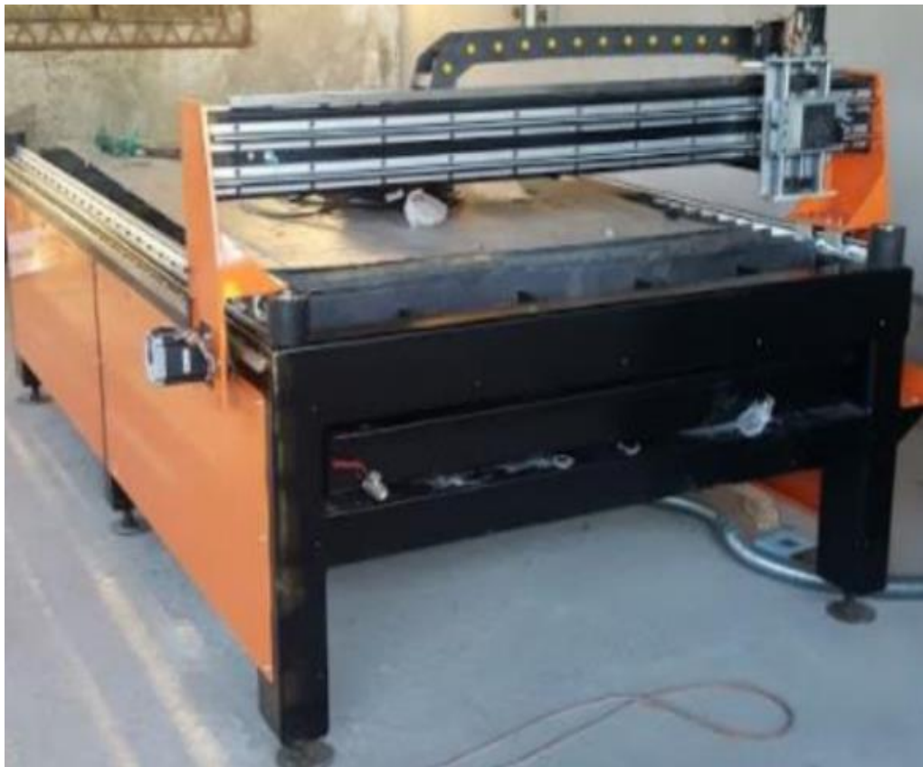
Figura 5: Máquina CNC, cortadora plasma. Fuente: (Suntaxi Alava, 2017)
