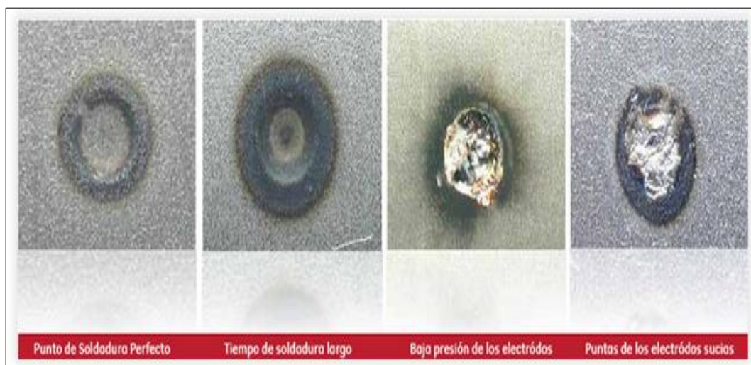
Figura N°18.- Tipos de puntos de soldadura Fuente: Departamento de calidad OBB Elaborado por: El Investigador
