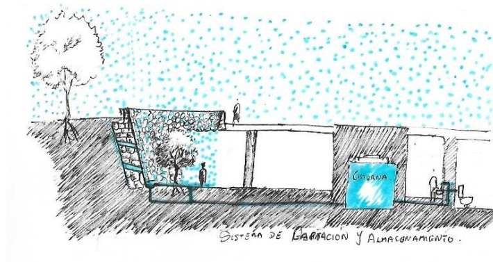
Gráfico 27: Sistema de recolección de y uso del agua lluvia Fuente: Elaboración propia
