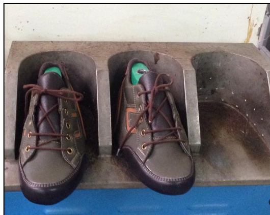
Imagen 8 Vaporización de taloneras Calzado Kiddo Fuente: Calzado Rexell
