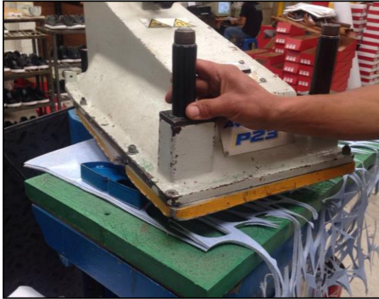
Imagen 5 Proceso de Troquelado Calzado Kiddo Fuente: Calzado Rexell
