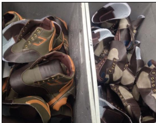
Imagen 6 Cortes Aparados Calzado Kiddo Fuente: Calzado Rexell
