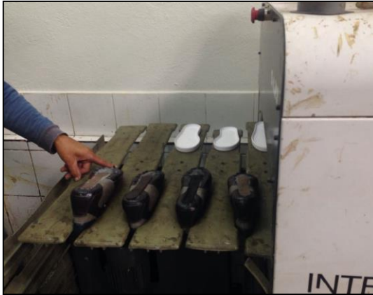
Imagen 11 Calentamiento de suelas Calzado Kiddo Fuente: Calzado Rexell
