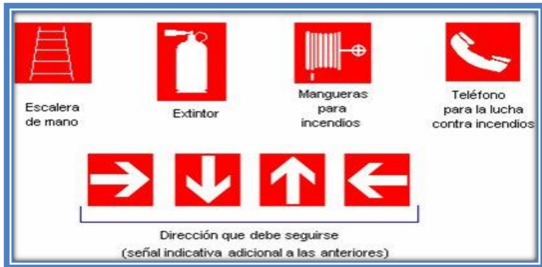
Imagen 13. Señales de equipos de lucha contra incendio.
