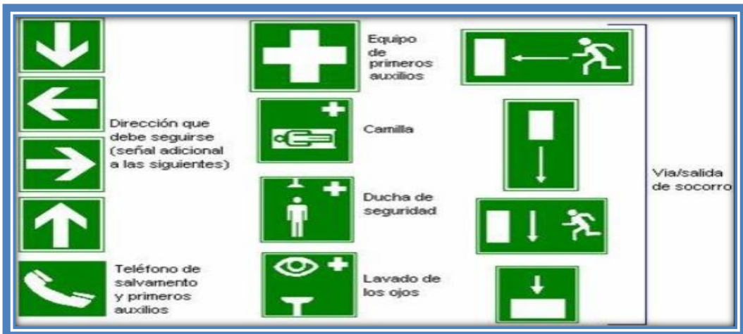
Imagen 12. Señales de salvamento o socorro.
