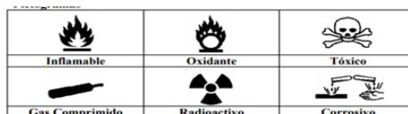
Fig. N° 1: Ejemplo de placa o etiqueta
