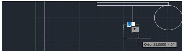
**Figura 68. Trazado de rectas perpendiculares**
