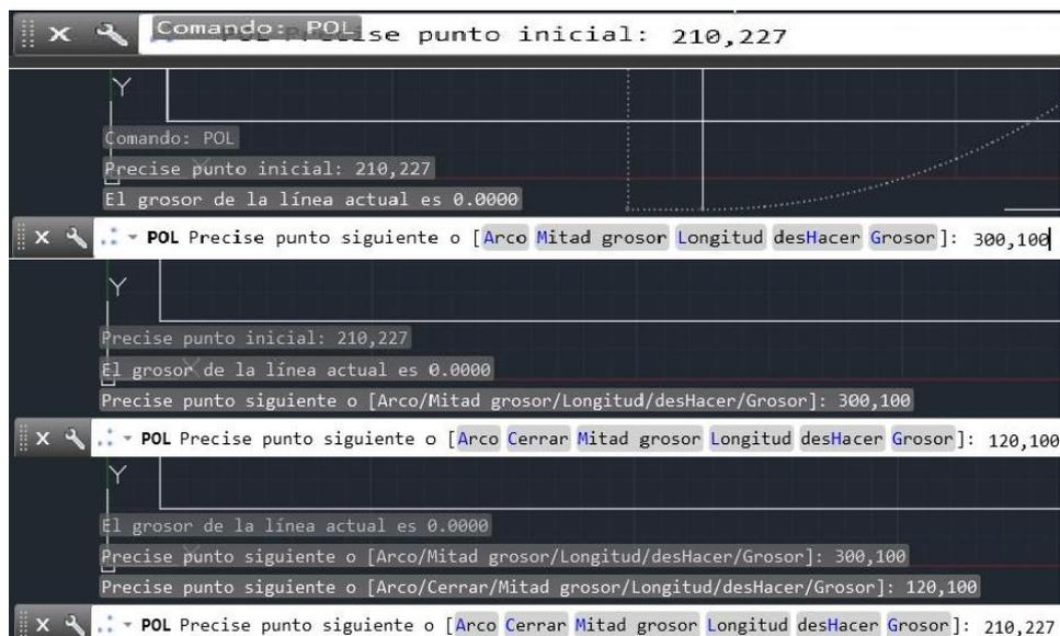
**Figura 34. Trazado de triángulo con el comando “Polilínea”**
