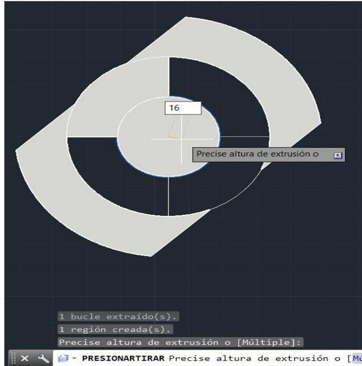
**Figura 111. Comando “Presionartirar” – altura de extrusión 2**
